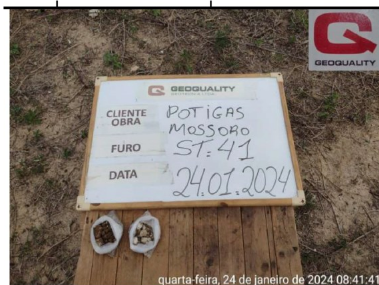
Imagem 08 - Aspecto do material extraído da sondagem ST-41 – Areia e pedregulho
