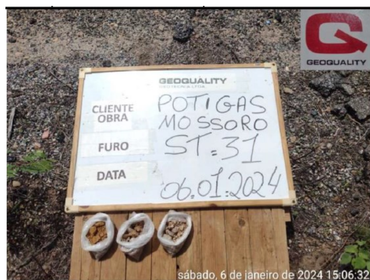
Imagem 09 - Aspecto do material extraído da sondagem ST-31 – Areia e pedregulho
