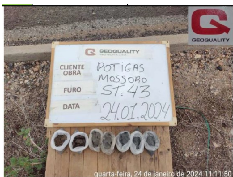
Imagem 07 - Aspecto do material extraído da sondagem ST-43 – Argila cinza
