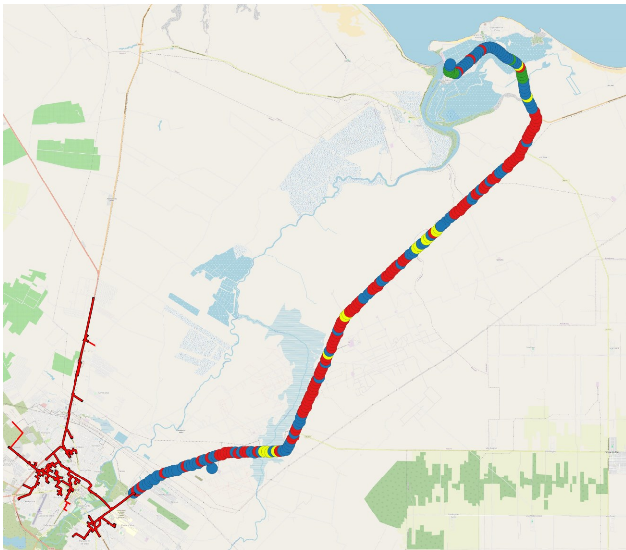
Imagem 05 – tipo de solo verificado em cada sondagem na porção que foi possível a penetração.
