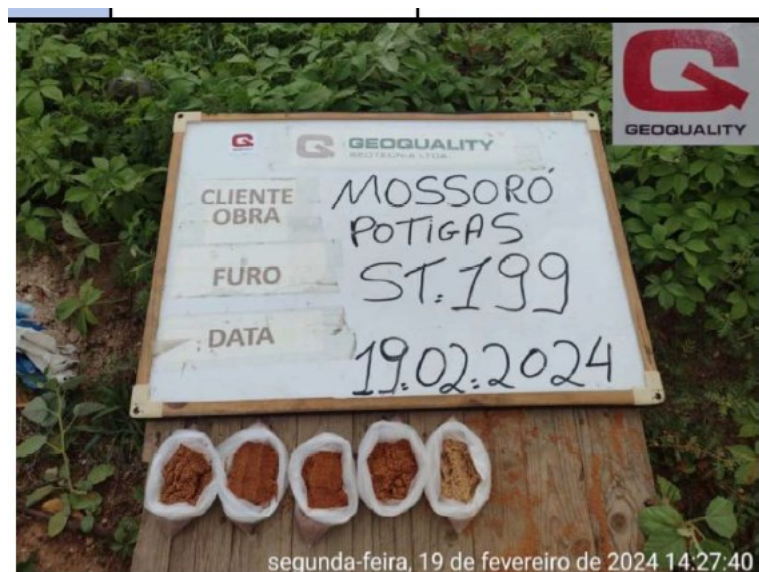
Imagem 10 - Aspecto do material extraído da sondagem ST-199 – Areia grossa e fina
